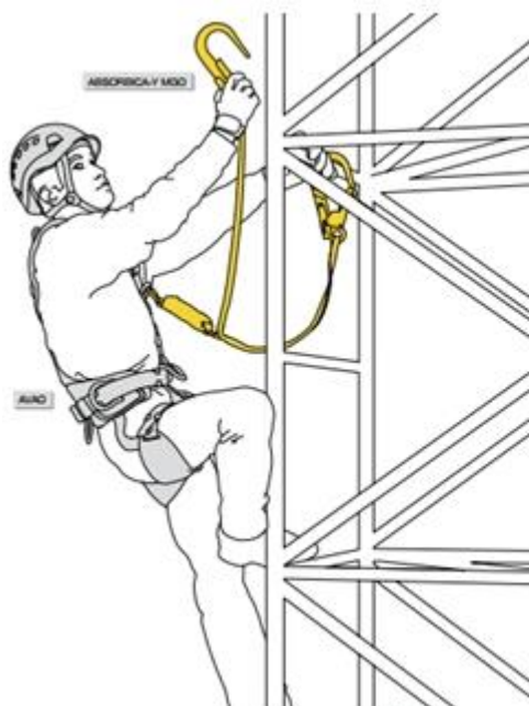
Используя двухплечевой страховочный строп можно перемещаться в пространстве, сохраняя постоянное соединение с опорой
